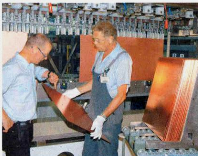
Kurz vor der Inbetriebnahme im umversetzten Erweiterungsbau: Galvaniseurmeister Georg Kimmich (links) und Anlagenführer Bernd Burkandt bestücken den Galvanoautomat mit so genannten Panels.
