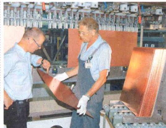
Kurz vor der Inbetriebnahme im unversehrten Erweiterungsbau: Galvaniseurmeister Georg Kimmich (links) und Anlagenführer Bernd Burkand bestücken den Galvanoautomat mit so genannten Panels.
