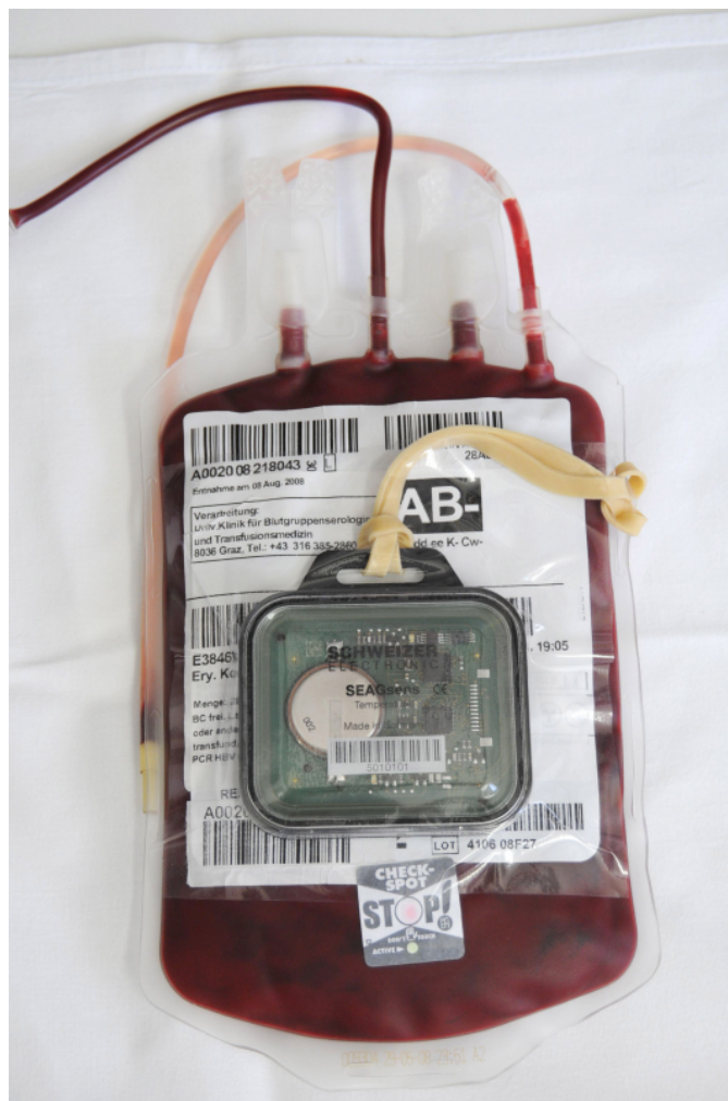
Bild: SEAGsens auf Blutbeutel (Schweizer Electronic AG)
