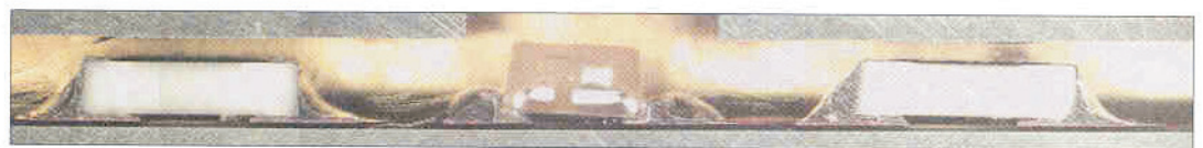
Bild 6. Das Schliffbild durch eine integrierte Frontplatte zeigt die Anordnung der SMT-Bauteile (LED, Widerstände) zwischen zwei Aluminiumblechen. (Quelle: Hofmann Leiterplatten GmbH)
