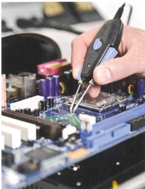
Sicheres Entlöten feinsten SMD Elemente mit der Entlötpinzette Chip Tool Vario
