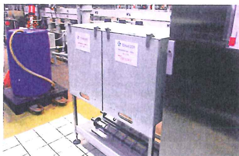
Barrenlot-Lagerkasten mit Zugriffssteuerung
