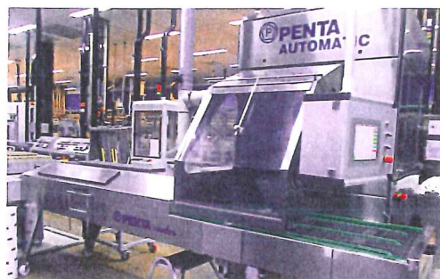
Kühlstrecke Penta Cooler
