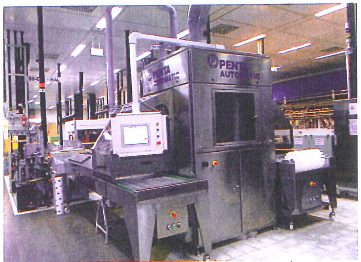
Penta Automatic mit Wechsellotpf (Gesamtansicht von der Bedienseite)
