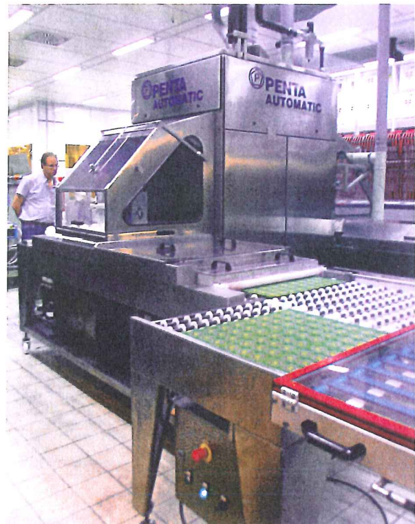
Zuführung mit Umsetzer zum Fluxer Penta HFL 700
