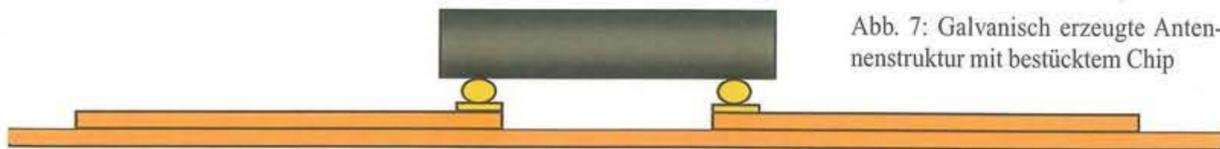
Abb. 7: Galvanisch erzeugte Antennenstruktur mit bestücktem Chip
