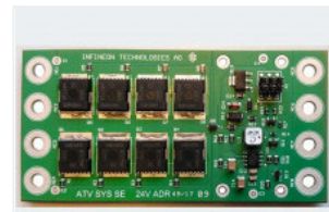
Bild 3: Demonstrator für einen 24-V-ADR-Batterieschalter für CAV-Anwendungen. (Bild: Infineon)
