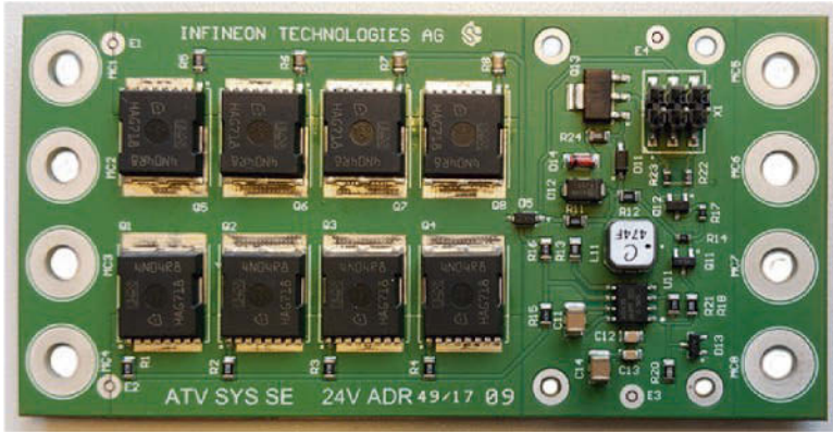
Bild 3: Demonstrator für einen 24-V-ADR-Batterieschalter für CAV-Anwendungen.
